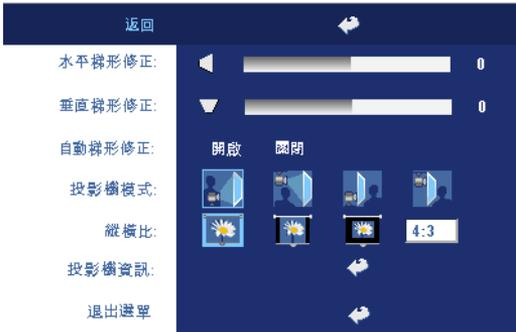
**垂直梯形修正** —修正因投影機擺設角度所造成的影像變形。
