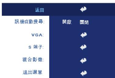
**訊號自動搜尋**—選擇**開啟** (預設)，自動偵測可使用的輸入訊號，在投影機開啓時按下**輸入源**按鈕，它會自動搜尋下一個可用的輸入信號；選擇**關閉**，鎖定目前的輸入訊號。當選擇**關閉**並按下**輸入源**時，就可選取想使用的輸入訊號。
