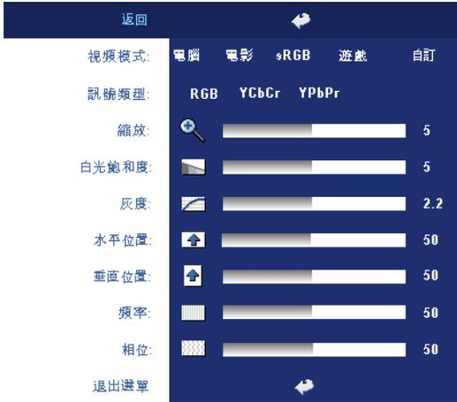
**視頻模式**—根據投影機使用的方式，選取一個使顯示影像最佳化的模式：**電影**、**遊戲**、**電腦**、**sRGB** (提供更精準的色彩呈現) 以及 **自訂** (可依您的喜好來設定)。如果您調整**白光飽和度**或**灰度**，投影機會自動切換至**自訂模式**。
