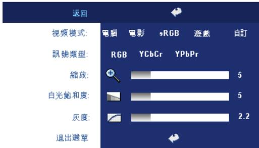
**視頻模式**—根據投影機使用的方式，選擇一個使顯示影像最佳化的模式：**電影**、**遊戲**、**電腦**、**sRGB** (提供更精準的色彩呈現) 以及 **自訂** (可依您的喜好來設定)。如果您調整**白光飽和度**或**灰度**，投影機會自動切換至**自訂模式**。
